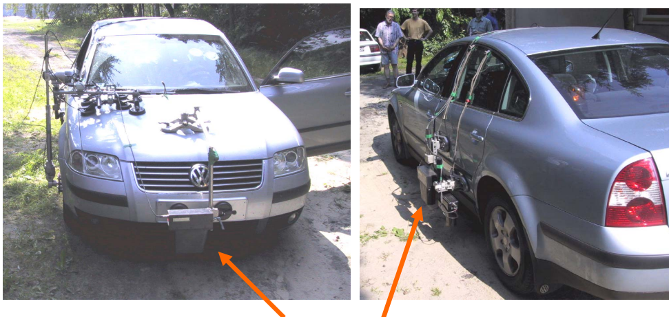
Fot. 3, 4. Samochód VW Passat z aparaturą. Strzałkami zaznaczono głowice Correvit H
