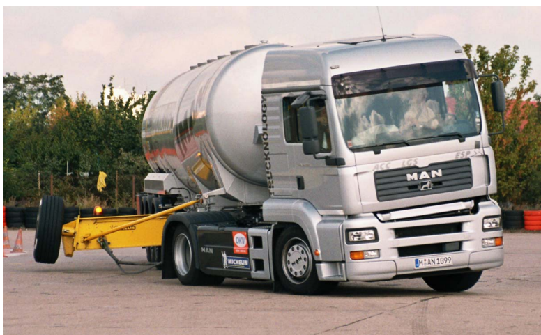
Fot. 1. Przechył ciągnika siodłowego MAN podczas próby gwałtownego skrętu w lewo
